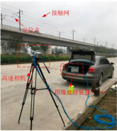
图3 京沪高铁接触网定位点抬升试验
